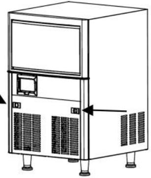
Pincez la languette de l'écran de filtre et tirez pour retirer le filtre afin de le nettoyer ou de le remplacer.
