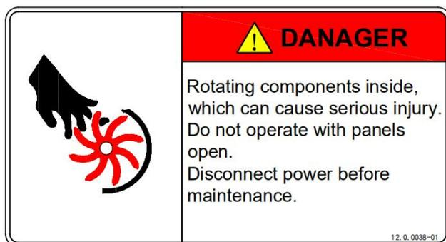
L'étiquette indique la présence de composants rotatifs à l'intérieur. Il existe un risque de blessures mécaniques graves.
