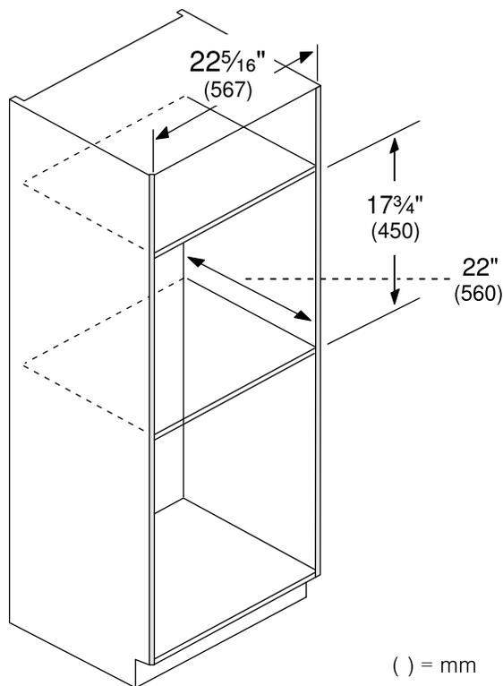
**MISE EN GARDE** : la base du meuble doit être plane et soutenir un poids d'au moins 64,1 kg.
