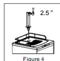
Tour de 2.5 " : Cela nécessite la tour boucle. Placez la tour de bière au trou dans la surface supérieure du distributeur de bière à une inclinaison de 60°, et tourner dans le sens horaire 60° long de la fente de la carte. Assurez-vous que le robinet soit dirigé vers l'avant de la machine. Fixez la tour de bière avec des rondelles. (Voir Figure 4).
