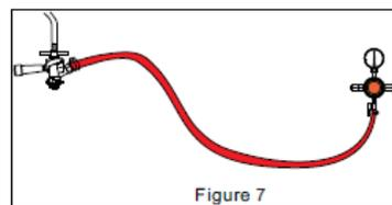
3. Installez la bouteille de gaz CO<sub>2</sub> et la soupape de régulation de CO<sub>2</sub>:
