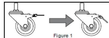
Installez les deux rondelles de roues universelles à l'avant de la base du cabinet, puis installer deux roues universelles sans freins à pied. Ensuite, installez les deux roues universelles avec freins à pied à l'arrière de la base du
