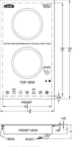
MODEL: CR2B15T1B CR2B15T2W 120V-60HZ 2400W MAX.
