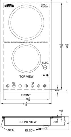
MODEL: CR2B23T3B CR2B23T4W 220-240V-60HZ 3000W MAX.
