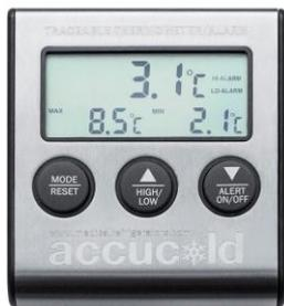
Chaque unité MED est équipée d'un thermomètre/ alarme qui affiche simultanément les températures minimale, maximale et intérieure actuelle et fournit un signal visuel et sonore lorsque la température à l'intérieur de l'unité tombe en dehors de la gamme de température réglée.
