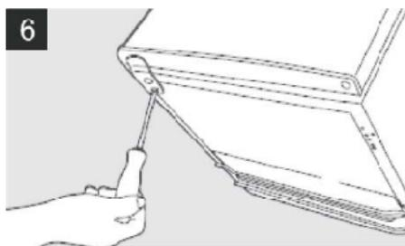
7. Vérifier que la porte est alignée horizontalement et verticalement et que les joints sont fermés sur tous les côtés avant de serrer la charnière inférieure. Réajuster le nivellement.
