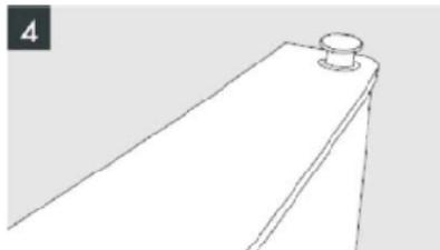
5. Avec un tournevis, enlever la goupille du support supérieur. Remplacez-la sur le support opposé. Vérifiez que la goupille est sécurisée.
