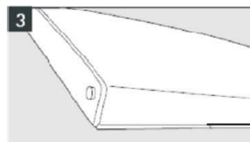
4. Retirer la douille d'articulation dans la partie supérieure de la porte et l'échanger avec le blanc de l'autre côté. Répéter l'opération avec la douille et le blanc sur le bas de la porte.
